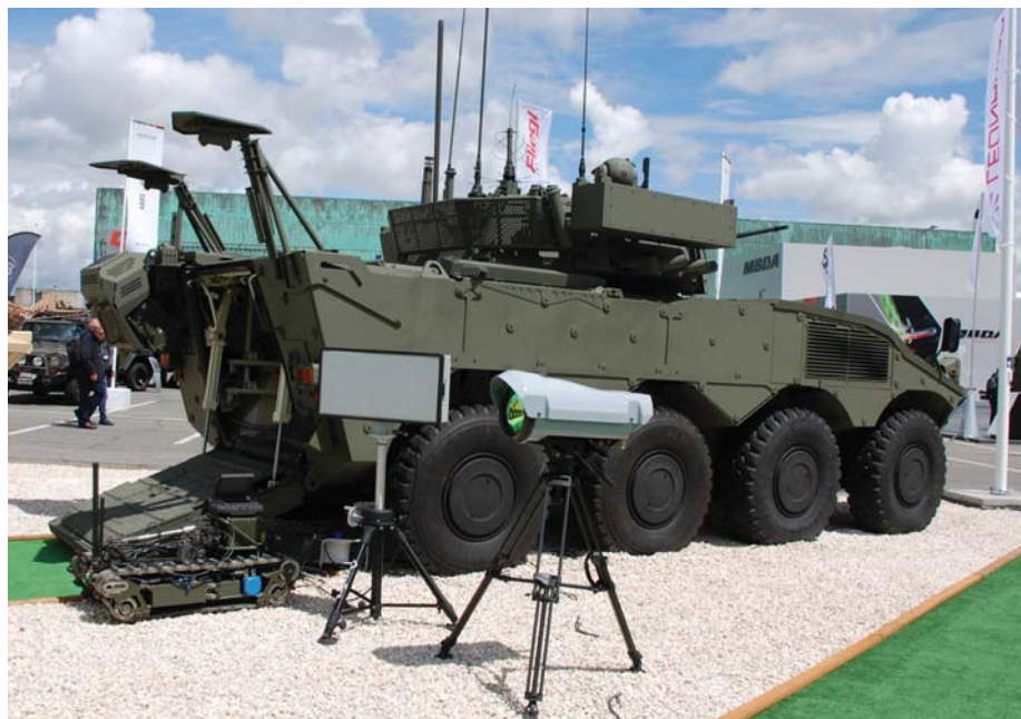
Una vista posteriore del VBM Esplorante nella sua configurazione "dimostrativa" che riunisce in un solo veicolo le dotazioni che nella realtà sono a bordo di 2 distinti mezzi. Si possono notare la camera termica HORIZON, il radar LYRA 10 e l'UGV TRP-2 RISTA Cavalleria (tutti sistemi realizzati da Leonardo). (foto: Eugenio Po)
