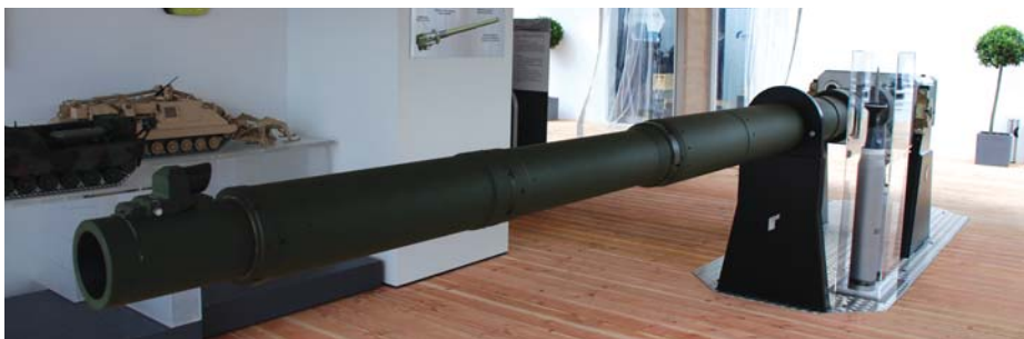
Il nuovo cannone Rheinmetall da 130 mm L51 costituisce una delle prime conseguenze pratiche derivanti dall'apparizione del nuovo carro T-14 ARMATA. (foto: Eugenio Po)
