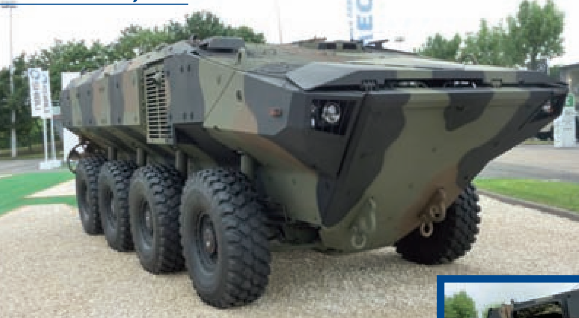
Il blindato anfibio 8x8 Iveco SUPERAV nella versione ACV 1.1.
