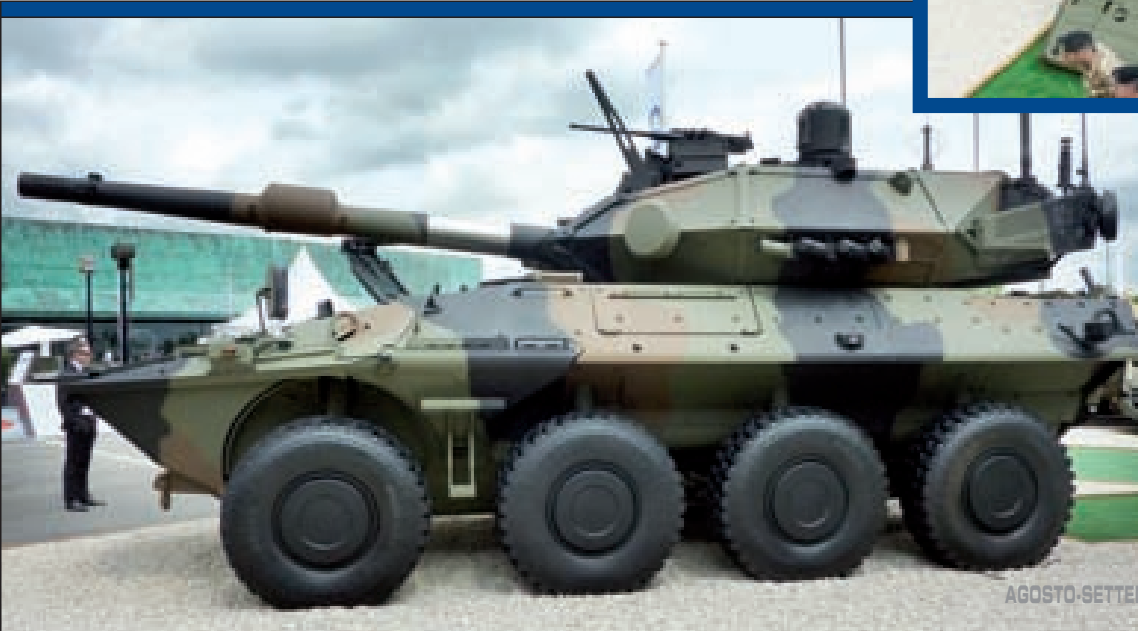
Il Centauro II. Notare le nuove antenne planari del sistema di jamming anti-RCIED Guardian H3. Sopra: il VBM Porta-Mortaio, con il pezzo rigato da 120 mm a caricamento semi-automatico 2R2M.
