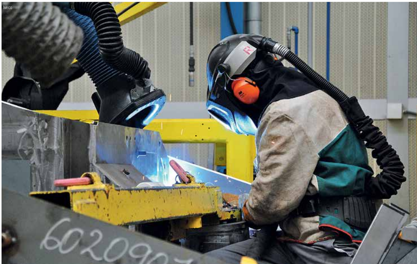
A soldagem da carroceria é uma das etapas mais críticas da produção de um blindado. Na unidade de Bolzano da Iveco, cerca de 60% é feita por robôs, o que diminui a necessidade de uma mão de obra especializada de difícil aquisição
